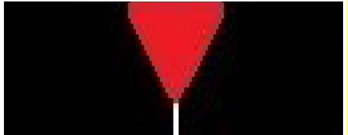
Soldadura incompleta, dejando un hueco en la raíz, lo que favorece la corrosión
